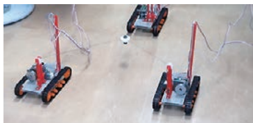
⑤ 移動機構とパラレルワイヤ駆動ロボットを組み合わせた例
